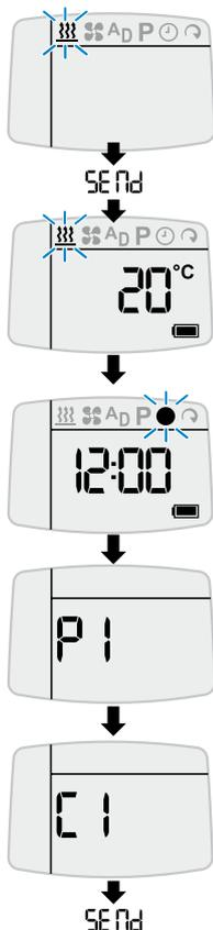
Wurde der Menüpunkt C1 / 07 mit bestätigt, werden die Daten übertragen. Anschließend wird die Uhrzeit angezeigt.
