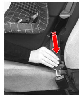
\*A protecção 33 do braço de encaixe protege o braço de encaixe ISOFIX 3 quando ele não for utilizado. Adicionalmente protege o assento do automóvel quando o assento de automóvel para crianças estiver preso com o cinto de 3 pontos.
