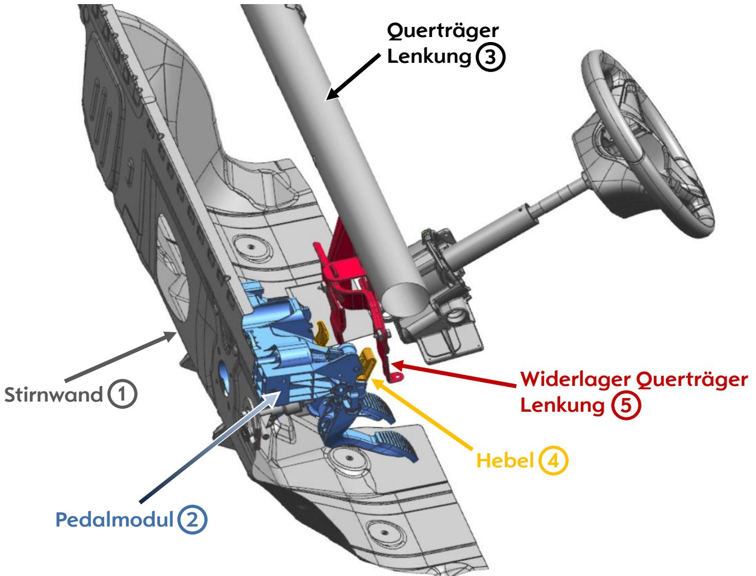
Die Stirnwand ① verschiebt das Pedalmodul ② in Richtung Querträger Lenkung ③.
