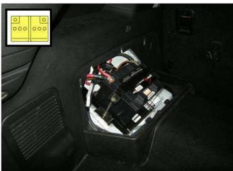
4. Abdeckung der 12 Volt Batterie im Kofferraum entfernen und Batterie abklemmen.
