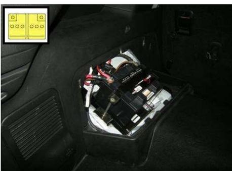
5. Abdeckung der 12 Volt Batterie im Kofferraum entfernen und Batterie abklemmen.
