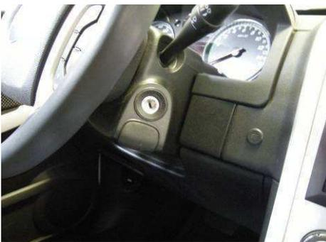
3. Zündschlüssel in die Position OFF (Aus) drehen und entfernen.
