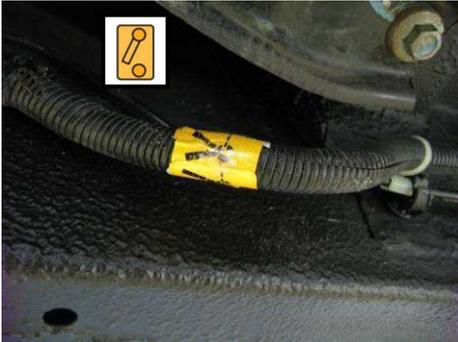
3. Eine der Kabelverbindungen am Fahrzeugboden trennen (gelbes Rettungskräfte-Label)
