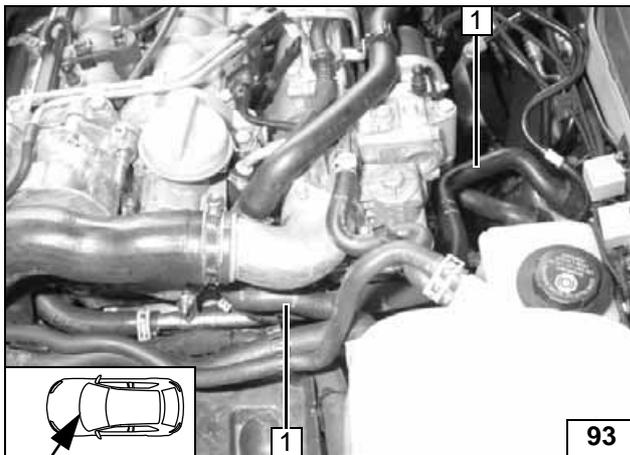
(1) Schlauch Motorausgang zum Wärmetau-
