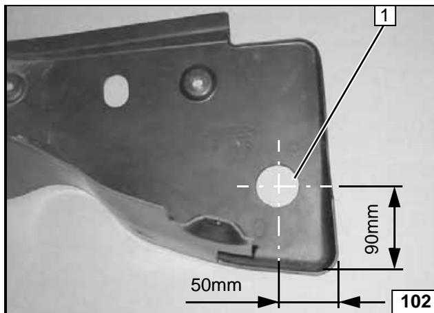
(1) Bohrung Ø 42mm
