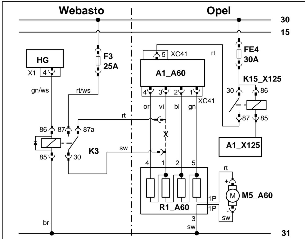
**Schaltplan manuelle Klimaanlage ohne Innenraumüberwachung**
