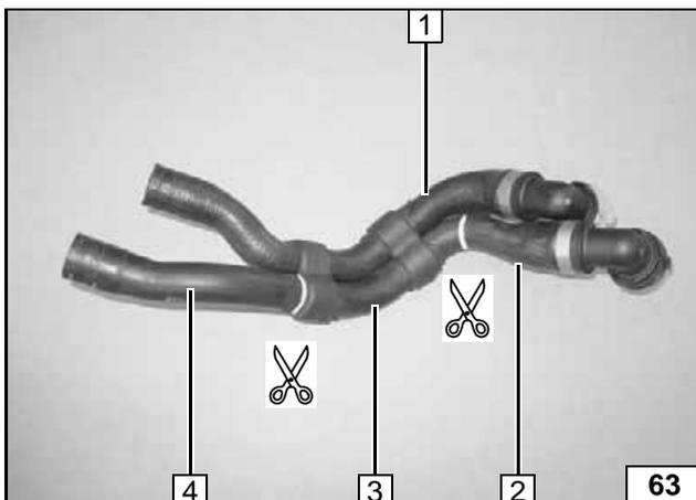
Schlauchgruppe **1** Motor / Wärmetauscher ausbauen und an den Markierungen trennen. Mittelstück **3** ist anvulkanisiert und bleibt an der Schlauchgruppe (ohne Funktion)!
