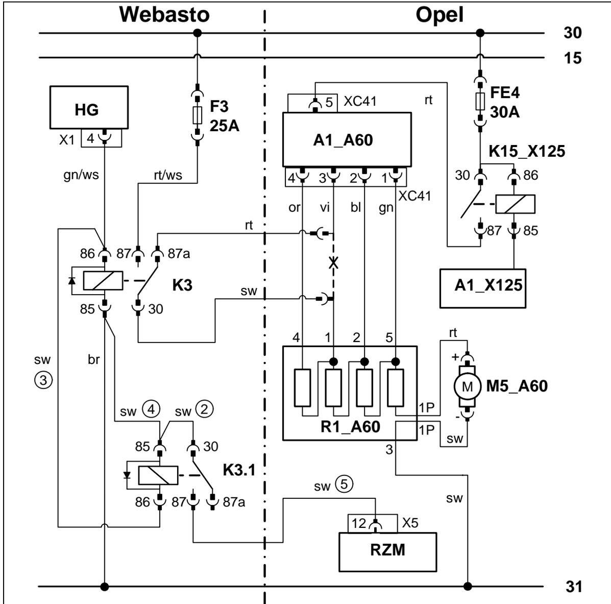
Schaltplan manuelle Klimaanlage mit Innenraumüberwachung
