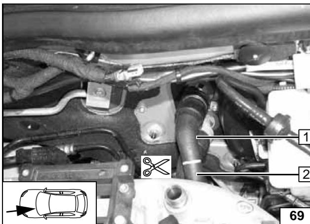
Schlauch Motorausgang / Wärmetauscher-
