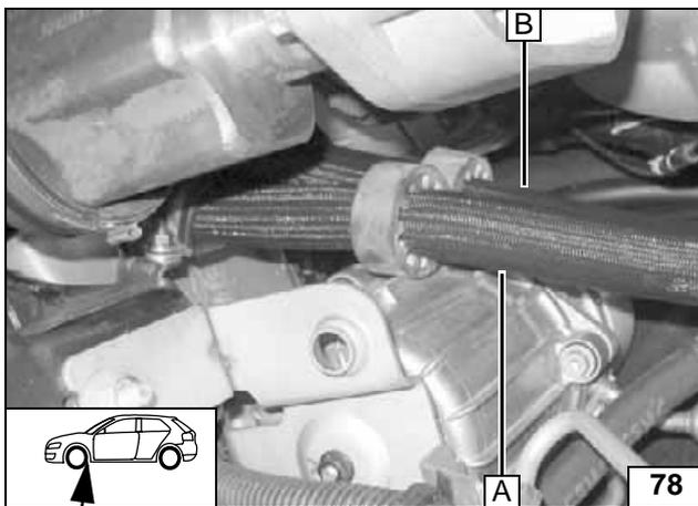
Profilgummi sw gemäß Bild positionieren
