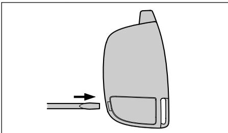
Drücken Sie mit einem Schraubendreher in die ca. 5 mm große Öffnung an der Unterseite des Gehäuses und nehmen Sie den Batteriedeckel mit dem Schraubendreher unter leichtem Druck nach innen heraus.
